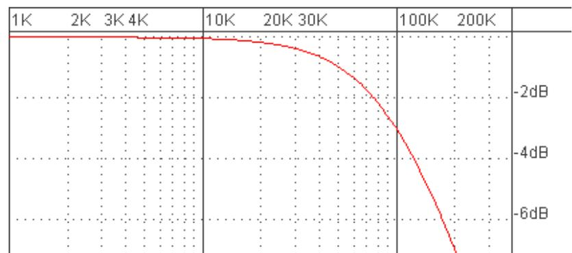
**Remarque :** afin d'obtenir une fréquence de 100Hz, on se fixe  $C=10\text{nF}$ , et comme la fréquence de coupure est :  $F_c = \frac{1}{2\pi RC}$  alors on déduit la résistance à mettre :  $R = \frac{1}{2\pi F_c C} = 159\Omega$ .
