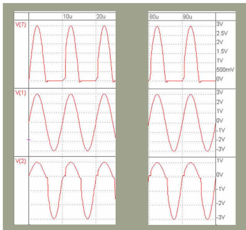
V(1) : signal d'entrée du démodulateur
