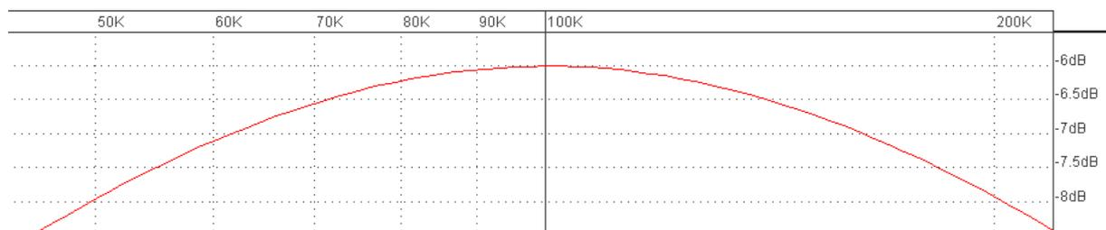
Le problème constaté est que la bande passante est trop élevée et que l'on diminue le gain. (-6db !). En effet, on a les recouvrements qualitatifs suivants :
