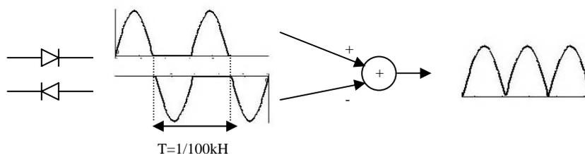
Ainsi, pour notre signal modulé, après filtrage par le filtre de butterworth et redressement, on obtient :
