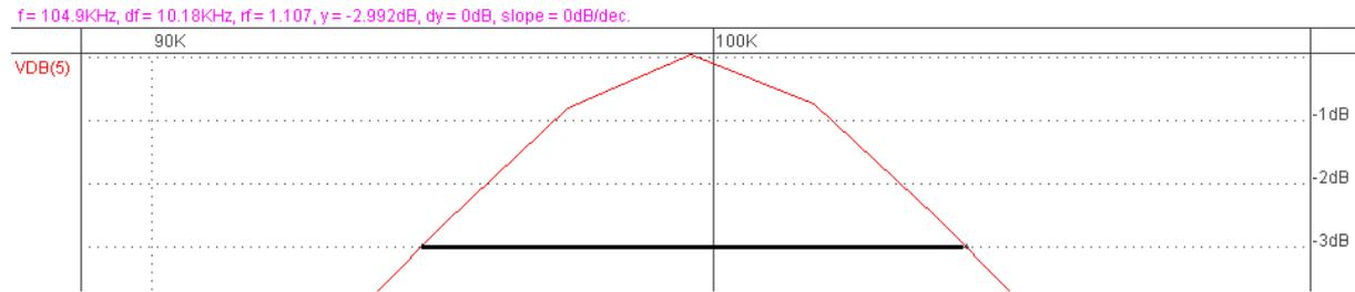
La réponse du filtre lorsque l'on applique un signal sinusoïdal à 100kHz en entrée est la suivante :
