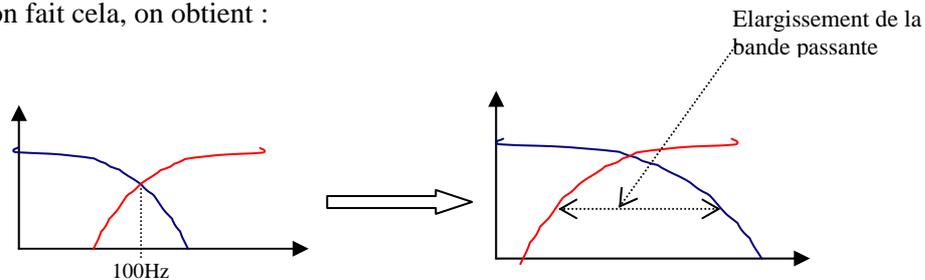
On augmente la Bande Passante. On ne peut donc pas avoir les deux contraintes simultanément, à savoir une bande passante étroite (10 à 15 KHz) et un gain nul. Le problème constaté n'est pas soluble avec cette architecture de filtre.
