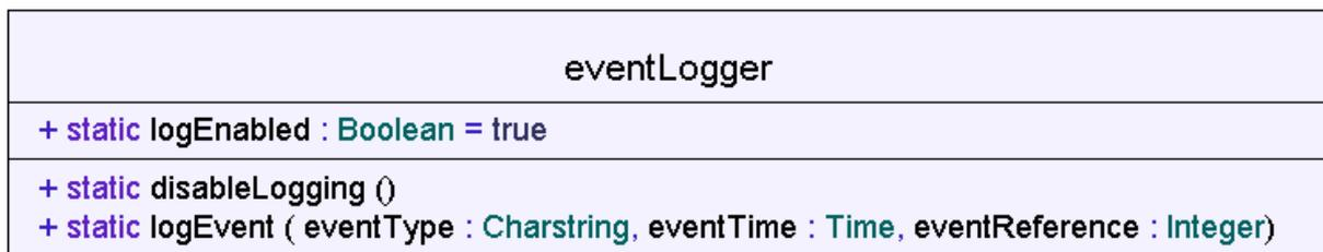
Figure 2 : Architecture de classe du traceur d'évènements
