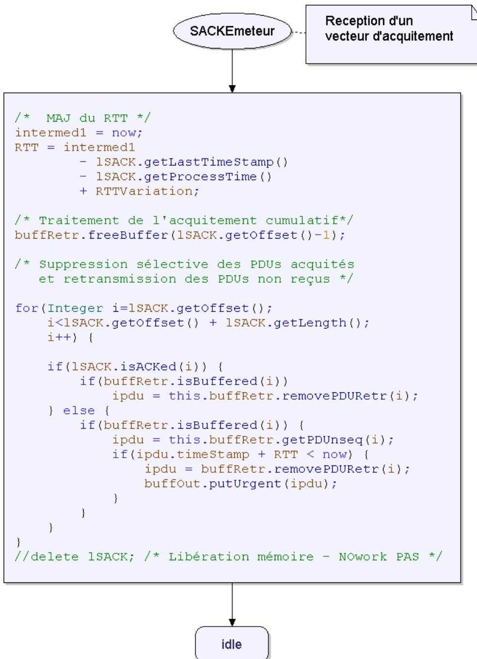
Figure 20 : Mécanisme déclenché à la réception d'un SACK (MG)
